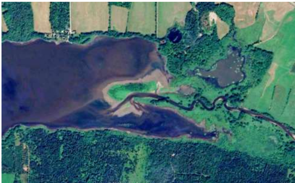
Photo 3 La section amont du lac à la Truite est progressivement envahi par le matériel granulaire provenant de la partie supérieure du bassin versant. Image satellitaire provenant de GoogleEarth.
