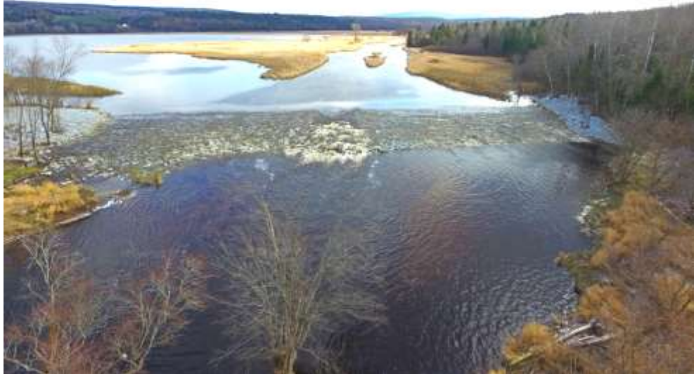
Photo 2 L'étang Stater a été créé pour favoriser la décantation des sédiments. Cependant, sa capacité est déjà pratiquement atteinte et le surplus de sédiments affecte les plans d'eau situés en aval. Photo gracieuseté de l'APLTI.
